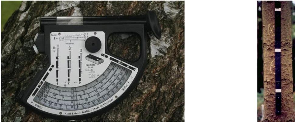
**Figure 25. Dendromètre Blum Leiss (appareil de mesure et mire)**
