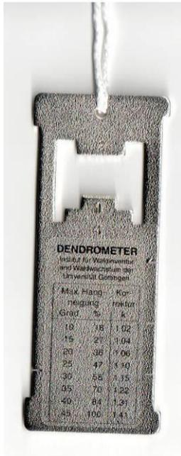
Principe : On vise le haut et le bas de l'arbre avec les encoches sur le bord gauche de l'appareil. Le trait gravé indique le 1/10<sup>ème</sup> de la hauteur mesurée. On mesure cette hauteur et on multiplie par 10 pour avoir la hauteur
