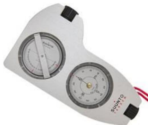
Figure 9. Tandem Boussole-Suunto
